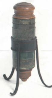
Microscopio composto: sec. XVII, attribuito a Giuseppe Campani. Il tubo è ricoperto di pelle e decorato. Le montature delle lenti sono di legno. Il microscopio è completo di lenti ed è inserito in un supporto di ferro a tre gambe.
