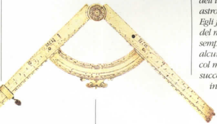
Compasso di Galileo, o compasso di proporzione funziona anche da regolo calcolatore.
